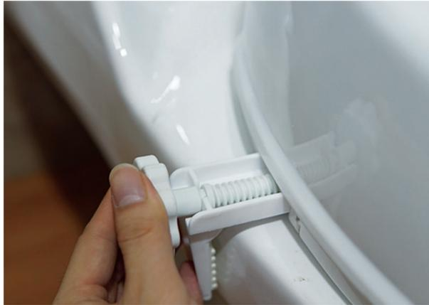
**Abb. 6:** Stellen Sie sicher, dass auf beiden Seiten die Klemmhalterung mit der rutschfesten Gummierung fest an der Toilettenschüssel anliegt.
